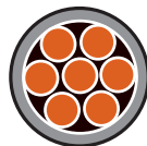
4 класс Гибкий многожильный проводник Кабель марки КГ
