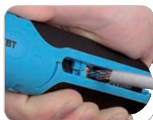
Зачистка коаксиального провода
